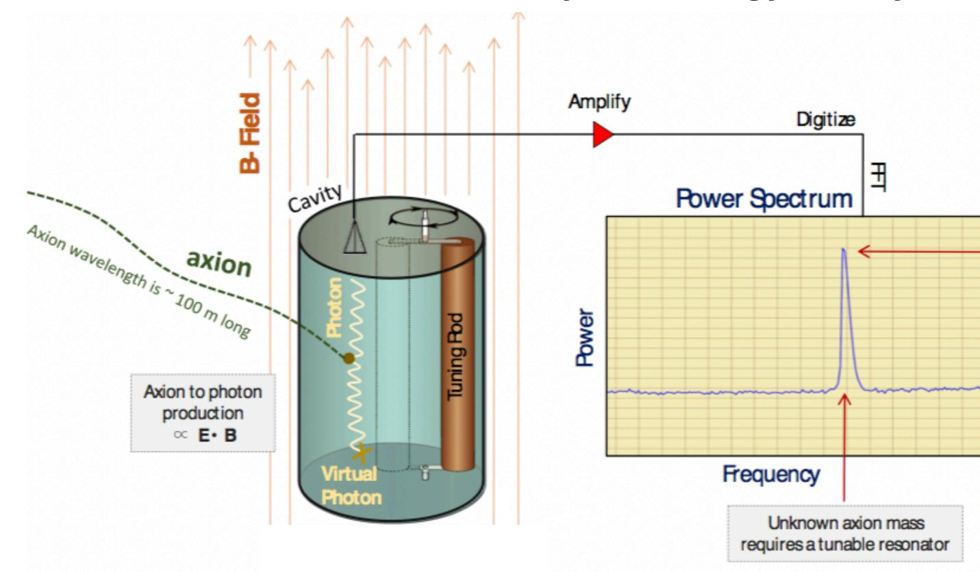
$a---- g_{a\gamma}$   $P_{signal} \simeq \mathcal{O}(10^{-22}\,\mathrm{W})$  X Noise floor from cavity blackbody radiation, plus
