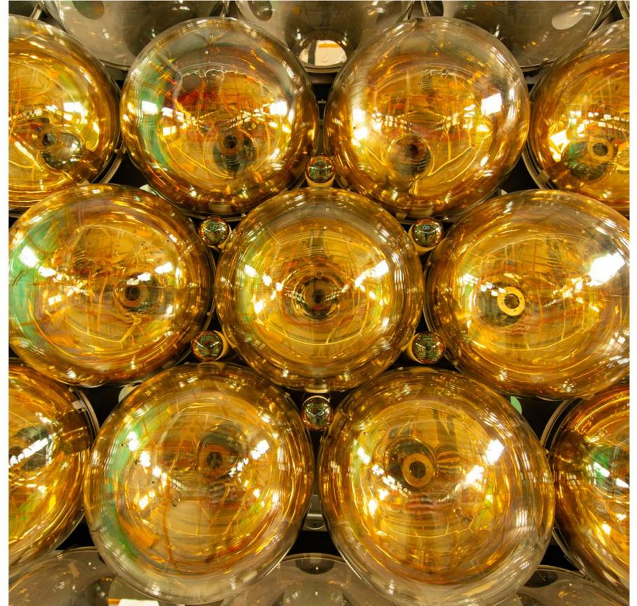
◆ 共45600支光电倍增管，通过光电效应探测微弱的光
