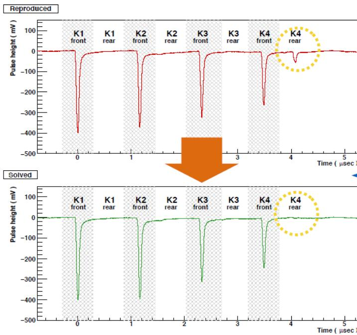
2021年，T78实验在COMET慢速提取模式下验证了多种解决K4束团远端泄漏的方案可行。
