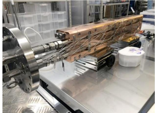
Phase-II, 钨屏蔽, 水冷系统设计。
