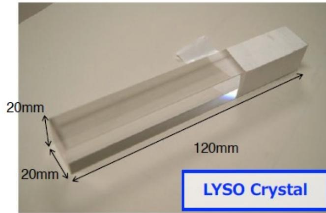
LYSO晶体原型机测试已完成。对105 MeV电子束流，能量分辨4%，位置分辨<6mm，时间分辨0.5 ns。
