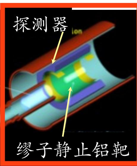
实验方法：每年约 $10^{16}$ 个带负电缪轻子被铝靶停止，形成1S态缪原子。
