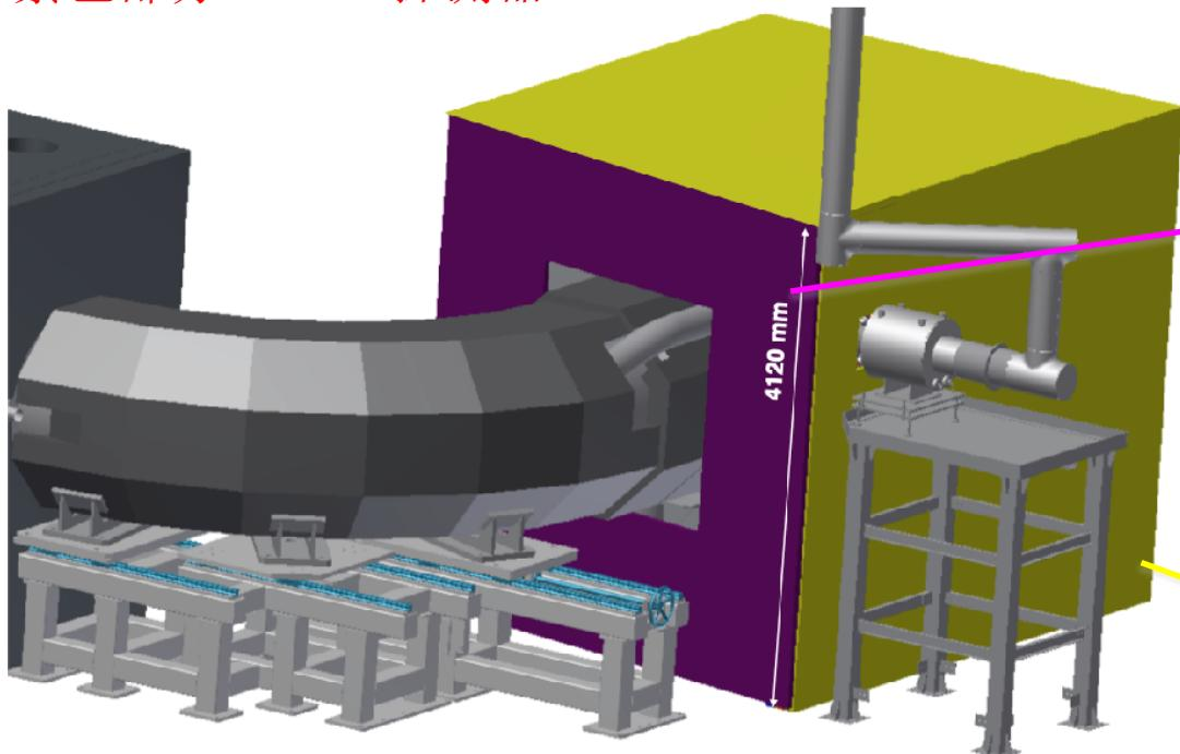
反触发系统设计指标：缪子探测效率高于99.99%。
