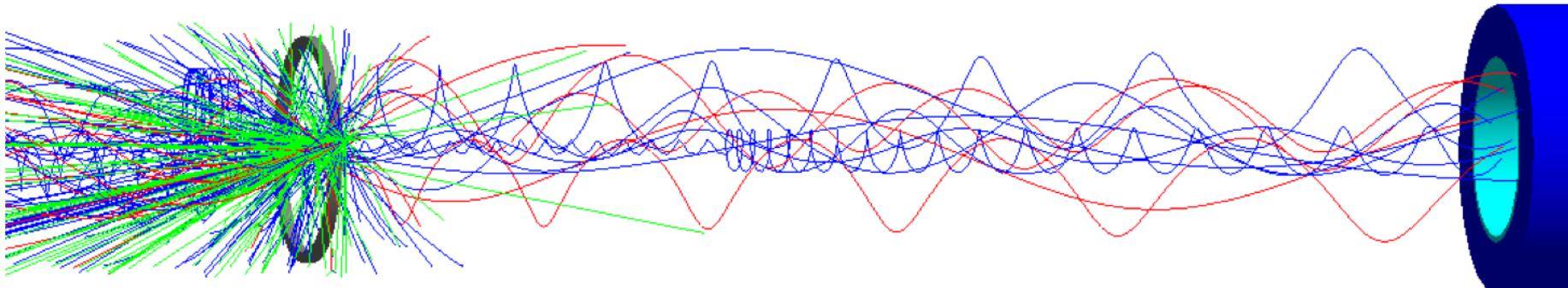
螺线管型超导磁场聚焦软pion介子，收集muon轻子
