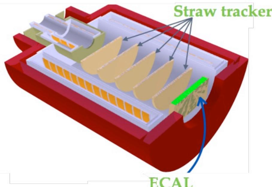
用于Phase-II的5mm直径，12 $\mu\text{m}$ 厚度的稻草管探测器于2019年研发成功。4倍压力测试成功。直径变化范围在120 $\mu\text{m}$ 以内。后续研究正在进行。
