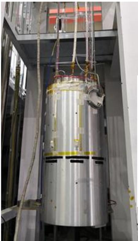
四极八极两组合超导磁体样机
